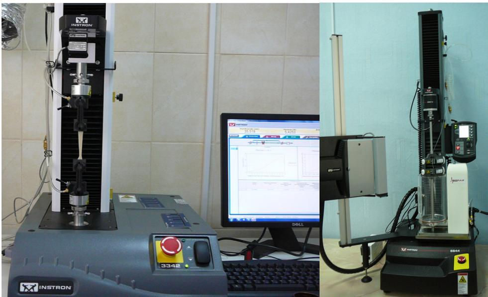
Рис. 1. Разрывные машины INSTRON- 3342 (слева) и INSTRON-5944 BIO PULS (справа)
